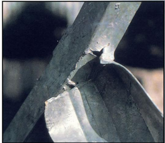
12. Έκρηξη. Ζημιά λόγω ακατάλληλου αερισμού. Μια έκρηξη μπορεί να συμβεί στο μπάνιο γαλβανίσματος εάν υπάρχει αέρας σε ένα κλειστό τμήμα (διαμέρισμα/θάλαμο) όταν η κατασκευή βυθίζεται στον λιωμένο ψευδάργυρο. Όταν ζεσταίνεται τους 450°C ο ατμός μπορεί να παράγει μία υπερβολική πίεση έως και 200bar και να σκάσει την κατασκευή. Ένα τέτοιο συμβάν μπορεί να είναι εξαιρετικά επικίνδυνο για τους χειριστές στο γαλβανιστήριο.
